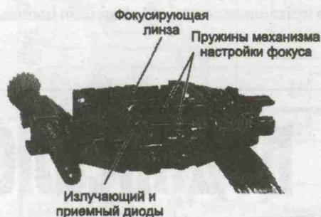
Рис. 1. Механизм лазерной головки без защитной крышки
